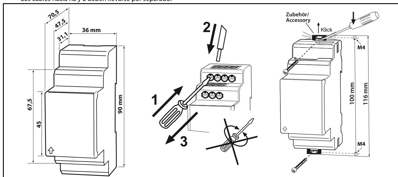
La tapa del panel frontal debe abrirse por la parte inferior marcada con una flecha.
